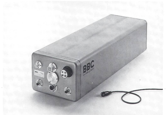
Figur 3 Hochenergiebatterie (265 kg, 250 dm 3 , 32 kWh, 50 kW)
