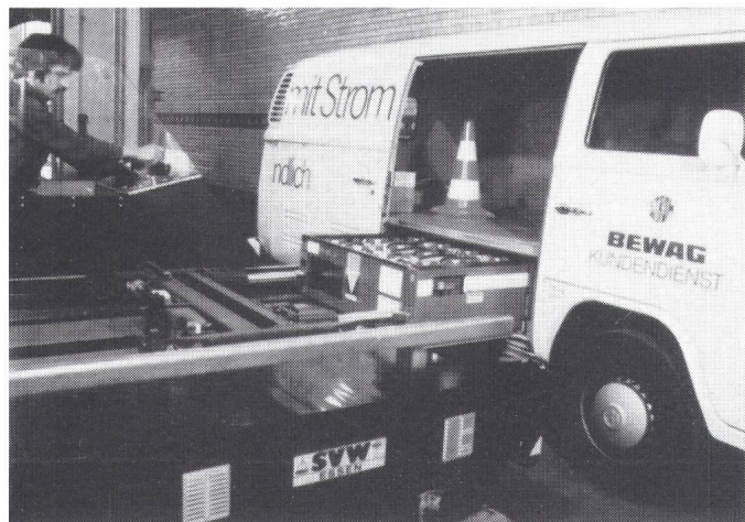
Figur 7 Der Batteriewechsel erfordert entsprechende Einrichtungen
