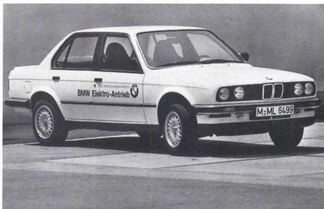
Figur 1 Der BMW 325 iX mit Elektroantrieb und NaS-Batterie
