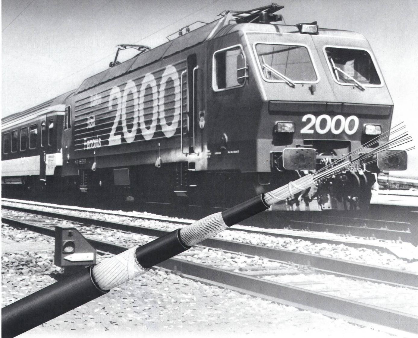
Entlang der Schienen in einer störbefüllten Umgebung verlegt, sind Bahnkabel für Nachrichtenzwecke den vom Schienenverkehr herrührenden elektromagnetischen Einwirkungen ausgesetzt.
