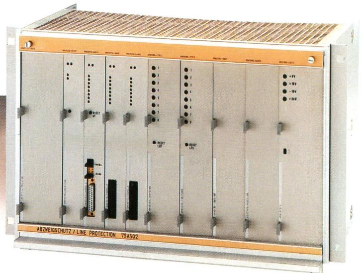
**Der mikroprozessorgeführte Selektivschutz 7S** besteht aus Stationsschutz und Abzweigschutz. Der Stationsschutz mit dezentralen und zentralen Intelligenzen sorgt für Sammelschienen- und Schaltversagerschutz. Der Abzweigschutz verfügt neben der Basisfunktion Distanzschutz über die Zusatzfunktionen Wiedereinschalten, Fehlerortung, Erfassen/Speichern von Kurzschlussdaten und Betriebsmessung.
