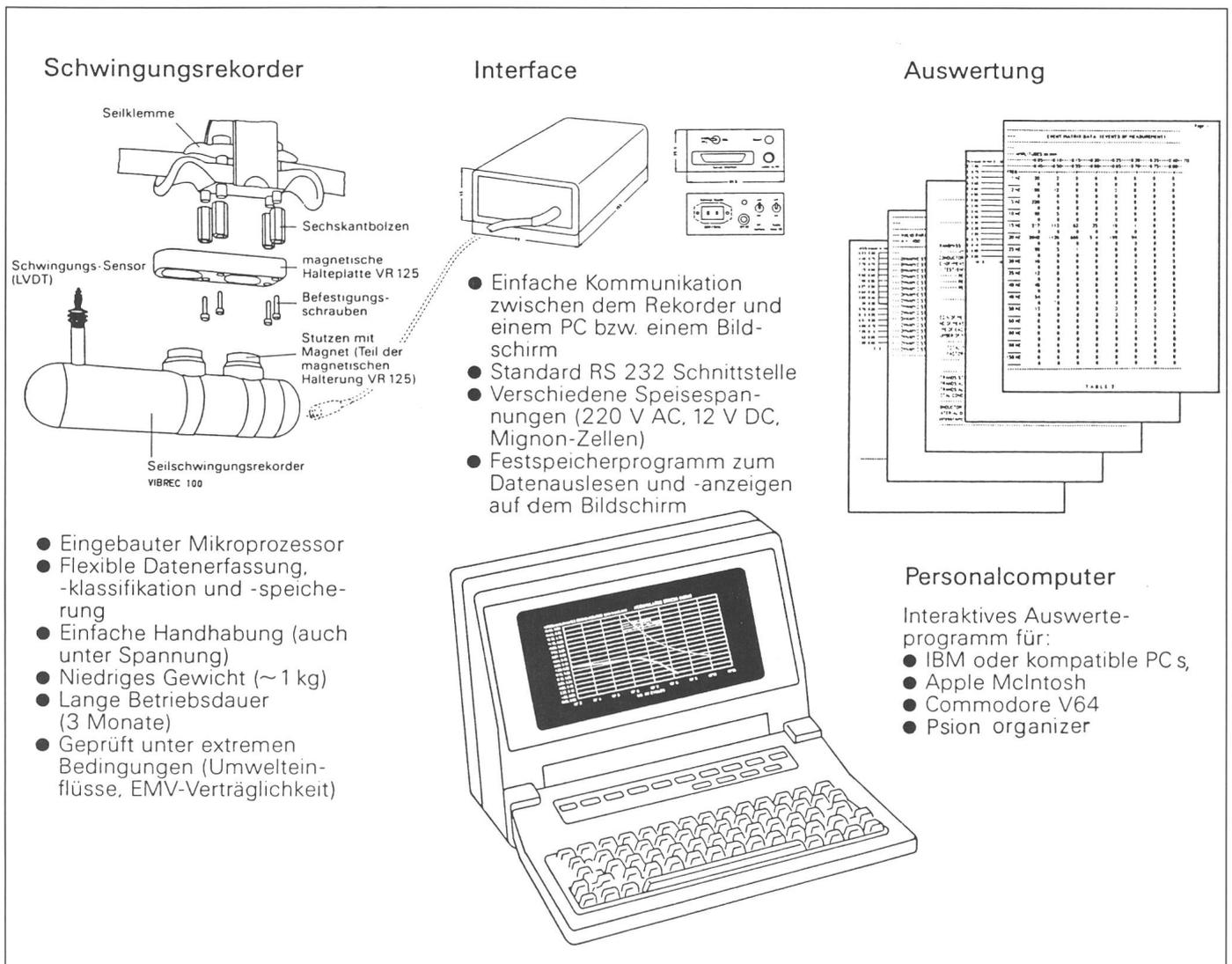
**Figur 6** Messsystem zur Schwingungsanalyse
