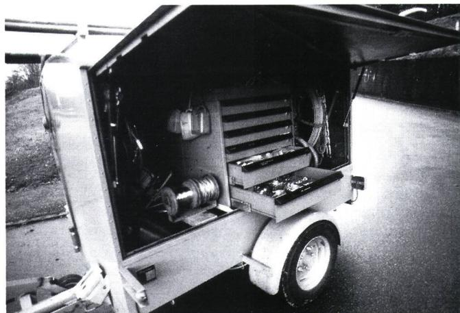
stangen. Die Seilwinde wird auch zum Ausrüsten der HS-Stangen mit Schaltern, Trennen usw. zu Hilfe genommen. Die Anwendungsmöglichkeiten der Seilwinde sind vielseitig. Auf dem Dachständer können Holzstangen (im Gelände), Leitern usw. und ausnahmsweise Kabelschutzrohre mitgeführt werden.
