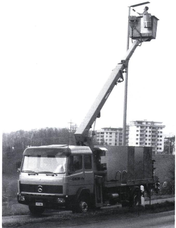
Figur 5 Mercedes-Lastwagen mit Arbeitsbühne
