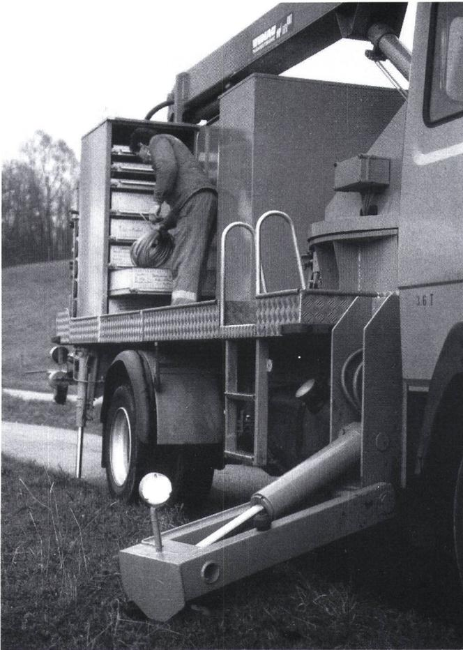
Figur 4 Mercedes-Lastwagen mit hydraulischen Stützen und Werkzeugkästen
