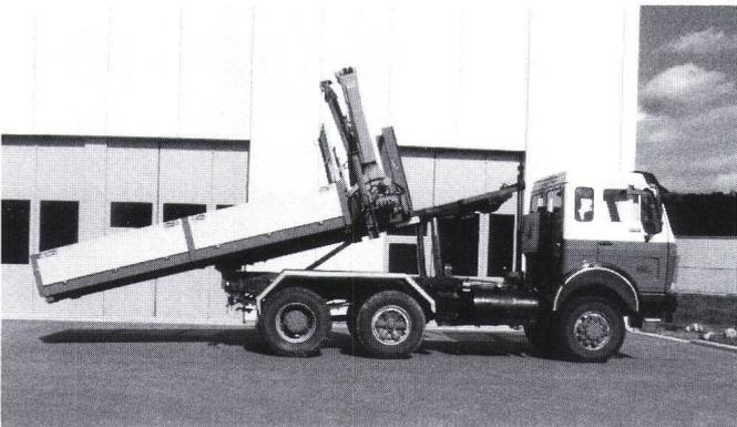
Figur 4 Aufziehen der mit einem Kran ausgerüsteten Brücke
