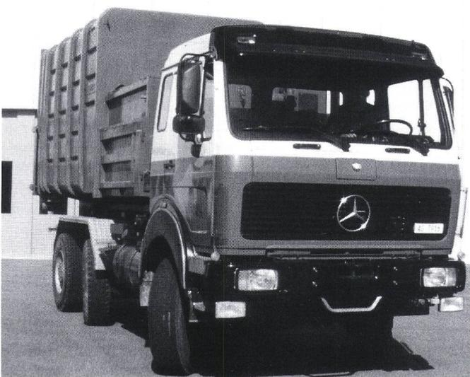
Figur 6 Lastwagen mit aufgebautem Kehrichtpresscontainer
