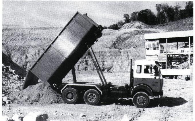
Figur 3 Entfernen der Schlammcontainer
