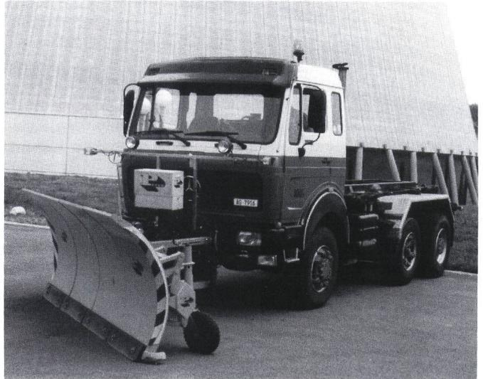
Figur 7 Lastwagen ohne Aufbauten mit Schneeräumungseinsatz
