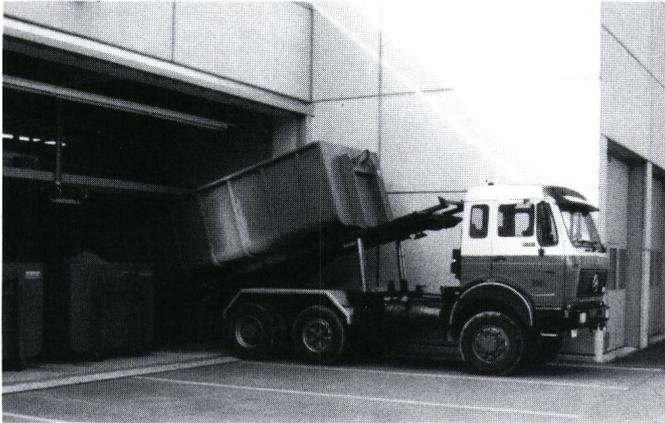
Figur 2 Aufladen der mit Schlamm beladenen Container
