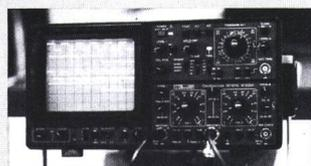
hochwertige Tastköpfe mit HF-Abgleich exakt an das Oszilloskop angepasst werden. Die verwendete Bildröhre mit einer Beschleunigungsspannung von 14 kV zeichnet ein helles und scharfes Abbild des Signalverlaufs. Damit sind Untersuchungen gleicher Signalausschnitte auch bei hohen Frequenzen möglich.
