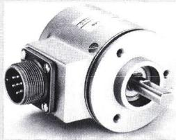
mehrere Signalausgänge. Je nach Anforderungen sind Ausführungen, die invertierte Signale sowie einen Nullimpuls liefern, verfügbar. Das Leichtmetall-Gussgehäuse schützt den Innenaufbau vor Umwelteinflüssen sowie vor Vibrations- und Stossbelastungen. Für Sonderanwendungen kann die kugelgelagerte, rostbeständige Stahlwelle mit einer Wellendichtung versehen werden.
