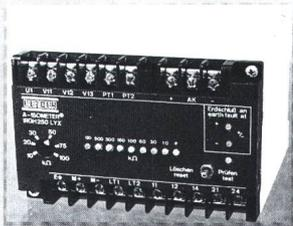
angeschlossenen Umrichtern zur Speisung von Elektromotoren sind die Geräte besonders geeignet. Dieses Messverfahren erlaubt eine relativ schnelle Erkennung von Isolationsfehlern. Die Ansprechverzögerung beträgt etwa 5 s bei einer Netzableitkapazität von etwa 1 µF. Das Gerät ist problemlos auf grössere Ableitkapazitäten einzustellen.
