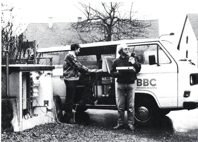
Figur 9 Messungen in einem 220-V-Netz. Fahrbare Messstation
