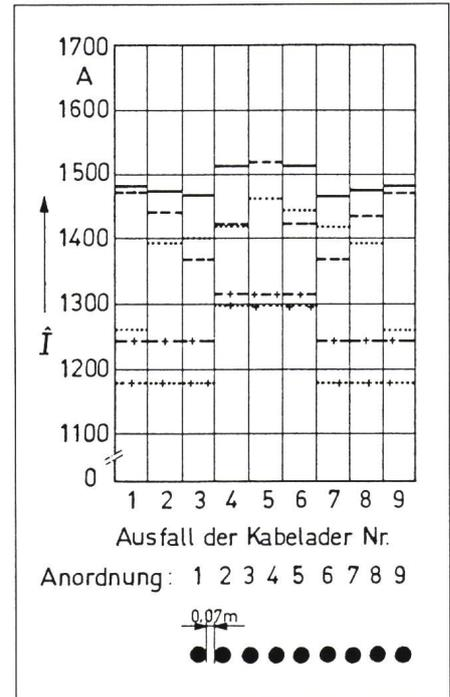
Figur 11 Residuale Systembelastbarkeit nach Ausfall einer Kabelader
