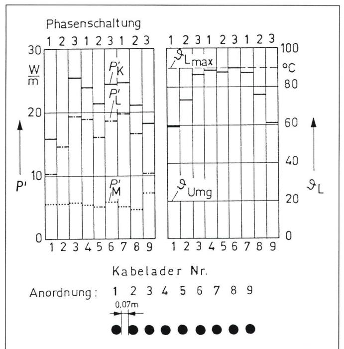
**Figur 4** Verlustleistungsbeläge und Leitertemperaturen der Kabeladern bei der Phasenschaltung I
