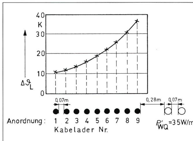
Figur 9 Erwärmung des Übertragungssystems durch zwei benachbarte Wärmequellen
