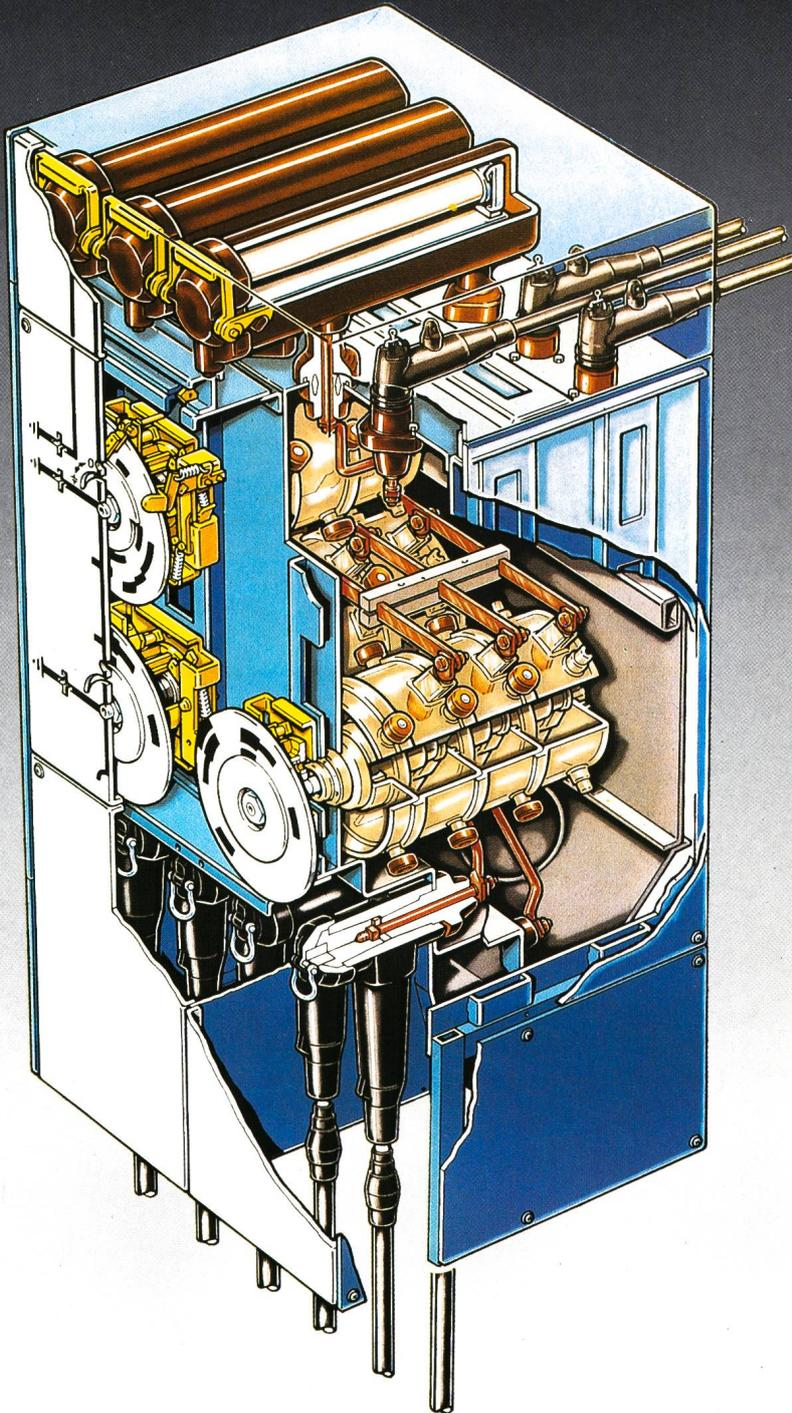
Die BTL ist eine SF<sub>6</sub>-isolierte Lasttrennschaltanlage für 12 bis 24 kV. Mit einer Höhe von 1,30 m, einer Breite von 0,80 m und einer Tiefe von 0,68 Metern das Kompakteste, was wir Ihnen je bieten konnten.
