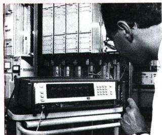
len der Kabel-, Richtfunk- und Satellitenübertragung bzw. an den elektrischen Schnittstellen optischer Übertragungseinrichtungen die erforderlichen Messungen durchführen zu können, ist eine Vielzahl wählbarer Bitraten, Bewertungsfilter und Schnittstellencodes vorgesehen. Unabhängig von der verwendeten Bitrate werden Jitter-Messungen an Takt- und Datensig-
