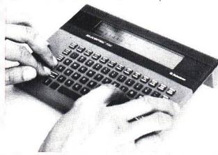
Schnittstelle (D-Sub, 9polig). Die Übertragungsraten kann per Software im Bereich von 150...9600 Baud eingestellt werden. Die Anzeige umfasst 4 Zeilen zu 40 Zeichen mit einer Zifferngröße von 5 mm. Optionen: anwendungsspezifische Software, Anschluss für Barcode-Lesestift, Schnittstelle für Druckeranschluss.
