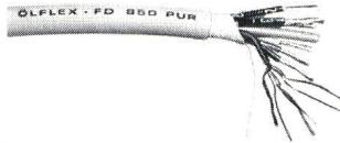
(0,07 mm) sind mit einem speziellen PVC isoliert. Der ganze Aderbund ist in kurzen Schlaglängen in Lagen verseilt, talkumiert und mit einem Textilband umwickelt. Ein neu entwickelter PVC-Aussenmantel unterstützt die Beweglichkeit und verhindert, insbesondere bei den Typen 850FD und 850FD-CY, ein gegenseitiges Aneinanderhaften mehrerer Leitungen. Zudem sind alle Typen mit Cu-abgeschirmtem Mantel lieferbar.
