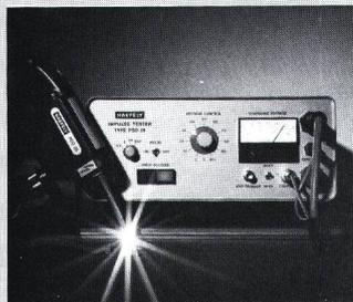
Normen durchgeführt werden können. Beim Prüfgerät kann die Polarität auf der Frontplatte gewählt werden. Es sind keine Zusatzgeräte dafür notwendig. Es lässt sich mit 230V/60Hz als auch mit 115V/50Hz betreiben. Um schnellere Impulsanstiegszeiten (~1 ns) zu erreichen, ist auch ein Relaisaufsatz verfügbar.
