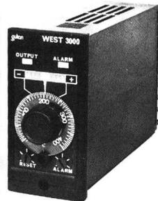
zur Verfügung. Die Geräte sind mit arretierbarem Drehknopf für die Sollwerteingabe, mit zweifarbiger Abweichungsanzeige sowie mit spritzwasser- und staubdichter Frontplatte ausgerüstet. Am Ausgang steht ein Relaiskontakt oder ein Logiksignal zur Ansteuerung von Halbleiterrelais zur Verfügung. Zusätzlich wird ein Alarmkontakt angeboten.
