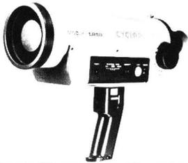
len. Mit Hilfe dieses Gerätes können Stromversorgungsunternehmen mögliche Störungen in Verteilernetzen vom Boden oder aus der Luft orten. Die Temperatur von Kabelverbindungen, Isolatoren und Schaltern sowie von überhitzten Lagern, Buchsen usw. lässt sich über einen Bereich von -20 bis +400 °C mit ±1% Genauigkeit messen.
