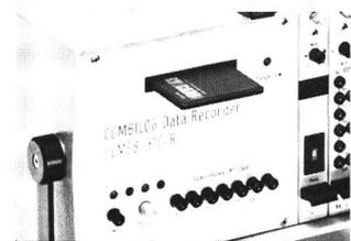
(ohne bewegliche Teile) und die robuste RAM-Speicherkarte erhöhen die Zuverlässigkeit des Systems wesentlich. Der vielleicht entscheidende Gewinn für den Kunden ist jedoch die erhebliche Preisreduktion beim Auswertesystem, welche dank diesem Fortschritt möglich wird. Die modulare Auswertesoftware CODAM, speziell für die Auswertung von Messungen im elektrischen Verteilnetz konzipiert und im In- und Ausland bewährt, kann ohne Änderung auch mit dem neuen Combilog-System verwendet werden.
