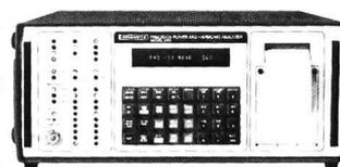
ter ausgedruckt werden. Zusätzlich kann der Analysator auch für weitere Zwecke verwendet werden, wie z.B. Netzimpedanzberechnungen, Evaluation von erzeugten Harmonischen in Generatoren und Speisegeräten, Auffinden von harmonischen Störungen, welche Kommunikationssysteme, Computer oder andere empfindliche elektronische Systeme beeinflussen können, Testen von magnetischen Materialien, Kalibration und Testen von Wattmetern, Vibrationsanalyse von rotierenden Maschinen usw.
