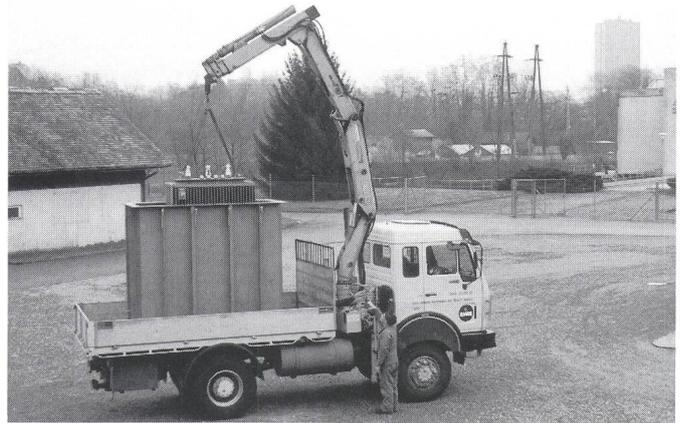
Figur 2 Strassentransport eines PCB-Transformators in einer Spezialwanne
