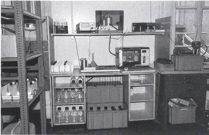
Figur 1 Transportable Prüfeinrichtungen für die wichtigsten Öltests
