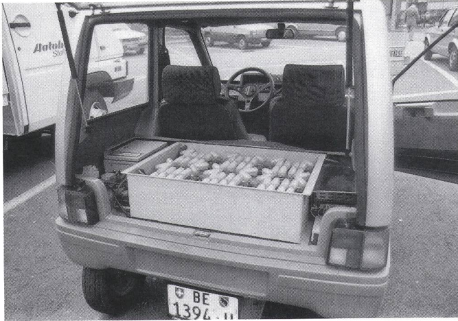
Der grösste Teil der 15 Batterien des Steyr Diamant ist unter der Gepäckraumabdeckung untergebracht
