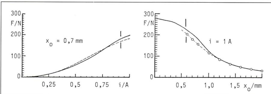
Figur 5 Kennlinien für die Lagerkraft eines Radiallagers
