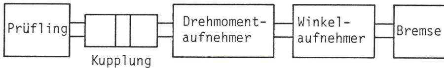
Figur 1 Mechanischer Aufbau des Prüfstandes für elektrische Antriebe
