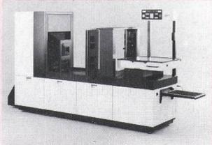
Dank dem automatisch einfallenden Raster können sowohl sämtliche Strich- wie auch Rasterarbeiten in äusserst kurzer Zeit erledigt werden. Die Tageslichtkamera Eskofot 8250 erlaubt die Herstellung von bis zu 5 Reproduktionen pro Minute.
