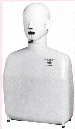
Der Kopf- und Rumpfsimulator 4128 trägt in hohem Mass zur Entwicklung akustischer und elektroakustischer Produkte bei.
