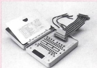
Leuchtdioden gibt Klarheit über den Zustand der Leitung: 1, 0 oder Unterbruch und ist auch aus schrägem Blickwinkel oder in abgedunkeltem Raum erkennbar.
