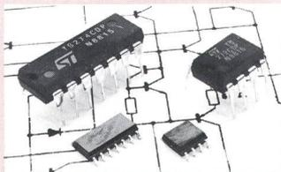
wie eine grosse Bandbreite und symmetrische Ausgänge. Sie sind alle mit integriertem elektrostatischem Schutz ausgerüstet. Die ganze Serie ist PIN-kompatibel an Standardoperationsverstärker. Drei Offsetspannungsversionen sind erhältlich: Standard mit 10 mV, A mit 5 mV und B mit 2 mV.
