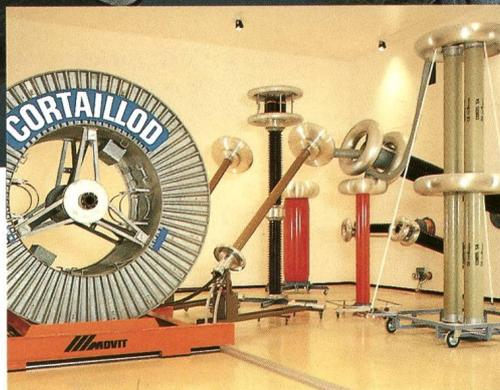
*Exclusivité Câbles Cortailod: laboratoire de mesure des décharges partielles pour câbles jusqu'à 480 kV*
