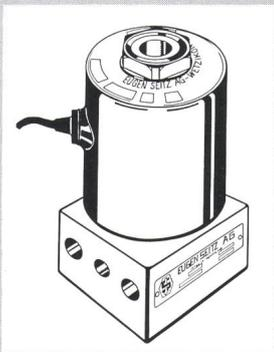
liertem Aluminium oder rostfreiem Stahl gefertigt; als Anschlüsse stehen verschiedene Gewinde oder Flansche zur Auswahl. Beliebige Einbaulage für Rohr- oder Flanschmontage. Die Innenteile bestehen aus rostfreiem Stahl, Weichdichtungen sind wahlweise aus NBR, FKM, EPDM oder PTFE erhältlich. Eine Auswahl von austauschbaren Magnetspulen für Gleich- oder Wechselspannungen von 6 bis 250 V sind in verschiedenen Bauformen und Schutzarten lieferbar.
