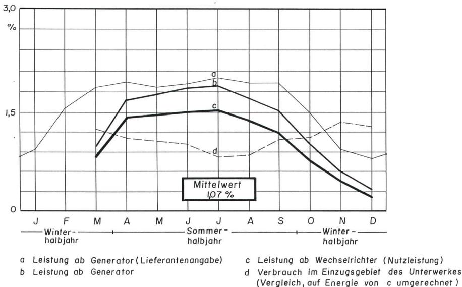
**Figur 6** Auswertungsergebnisse der netzgekuppelten Anlage ohne Speicher: Verlauf der Leistungsabgabe (Monatsmittel), Messreihe 1988,  $1000 \text{ W/m}^2 = 100\%$
