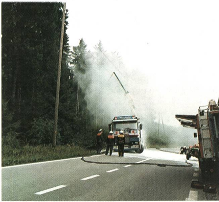
Figur 3 Ausgefahrener Lastwagenkranarm berührt 16-kV-Leitung: Todesfall und Pneumband
