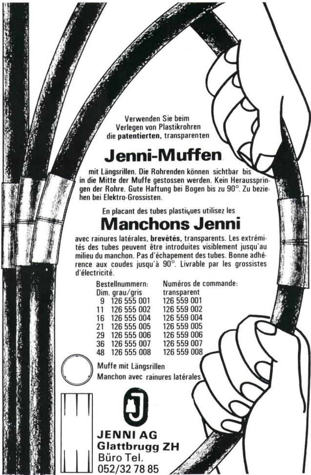
Verwenden Sie beim Verlegen von Plastikrohren die patentierten, transparenten **Jenni-Muffen** mit Längsrillen. Die Rohrenden können sichtbar bis in die Mitte der Muffe gestossen werden. Kein Herauspringen der Rohre. Gute Haftung bei Bogen bis zu 90°. Zu beziehen bei Elektro-Grossisten.
