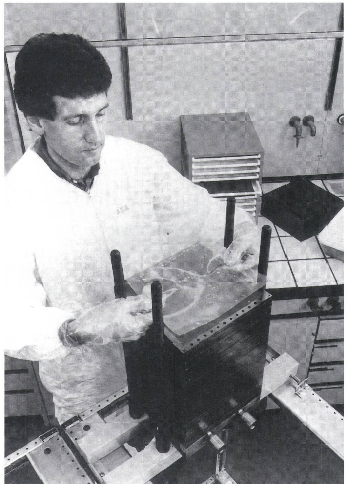
Figur 4 Auf einen Stapel von Membran-Elektrolysezellen wird eben eine weitere Membran gelegt. In einen Druckbehälter eingebaut, ergibt der fertige Stapel einen Elektrolyseur, wie er z.B. in der Versuchsanlage zur solaren Wasserstoffgewinnung im bayerischen Neunburg vorm Wald zum Einsatz kommt. (Foto ABB)
