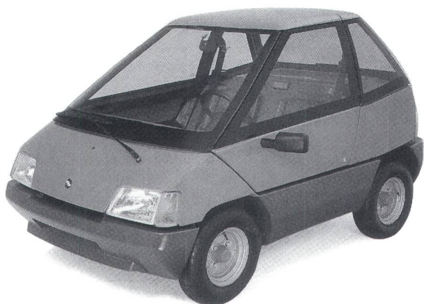
Neu: Der Pinguin 3 bzw. Maxi-El der Fridez Solar AG, mit nach oben aufklappbarem Dach, ca. 7-kW-Gleichstrommotor und ca. 60 km/h Höchstgeschwindigkeit (lieferbar ca. Sommer 1990)
