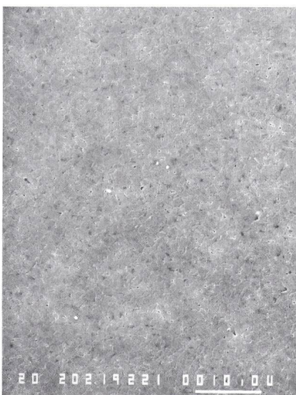
Bild 8 Fortgeschrittenes homogenes Gefüge einer Aluminiumoxid-Keramik
