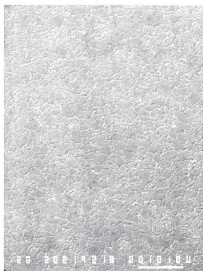
Bild 8 Fortgeschrittenes homogenes Gefüge einer Aluminiumoxid-Keramik
