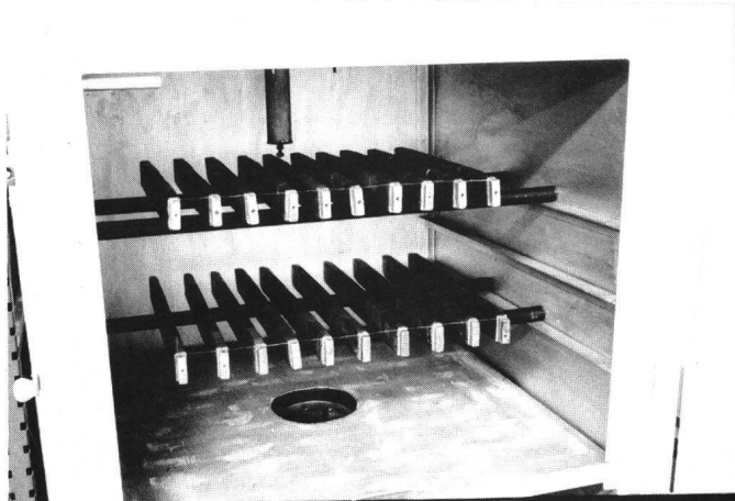
Bild 4 Alterungsöfen, mit 20 Normprüflingen bestückt
