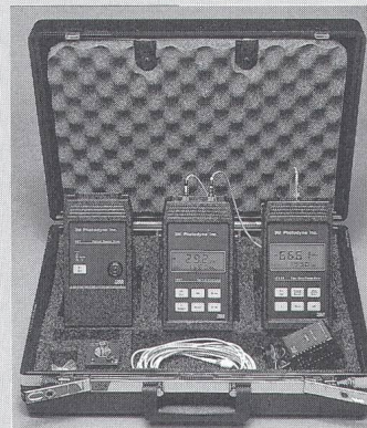
Die Lichtwellen-Leiter-Messeinrichtung im Koffer
