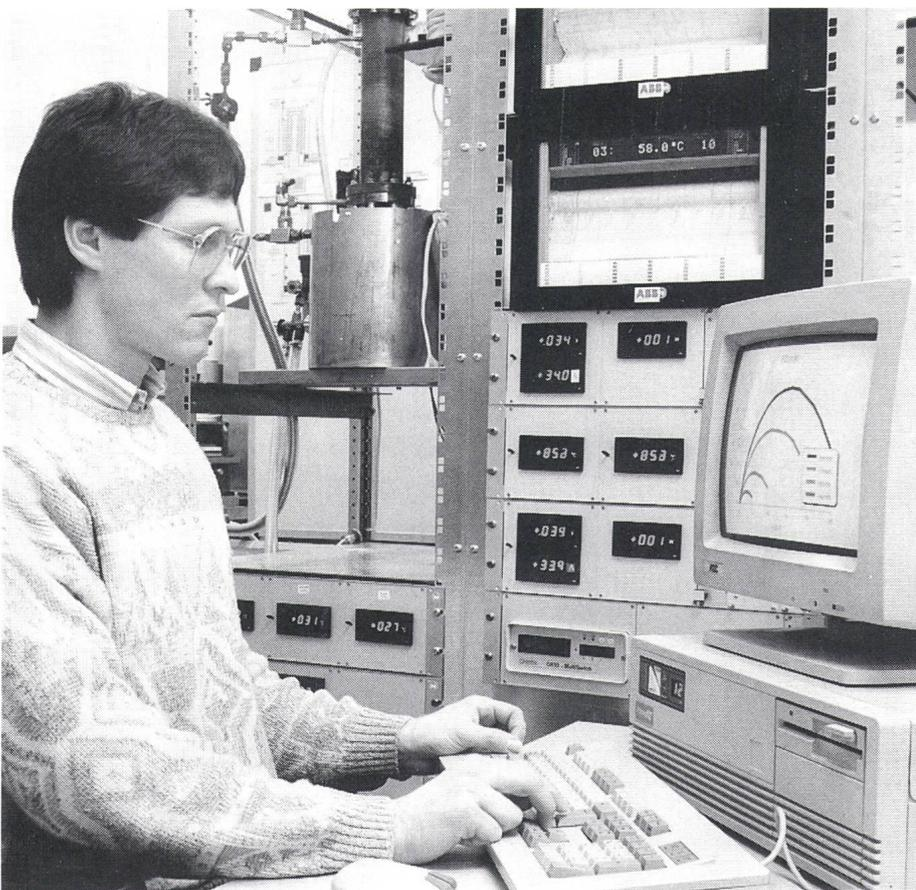
Bild 4 In zahlreichen Messreihen werden die Kennwerte – rechts auf dem Bildschirm Leistung über Stromstärke – von AMTEC-Versuchszellen ermittelt, um Anhaltspunkte für Verbesserungen zu finden
