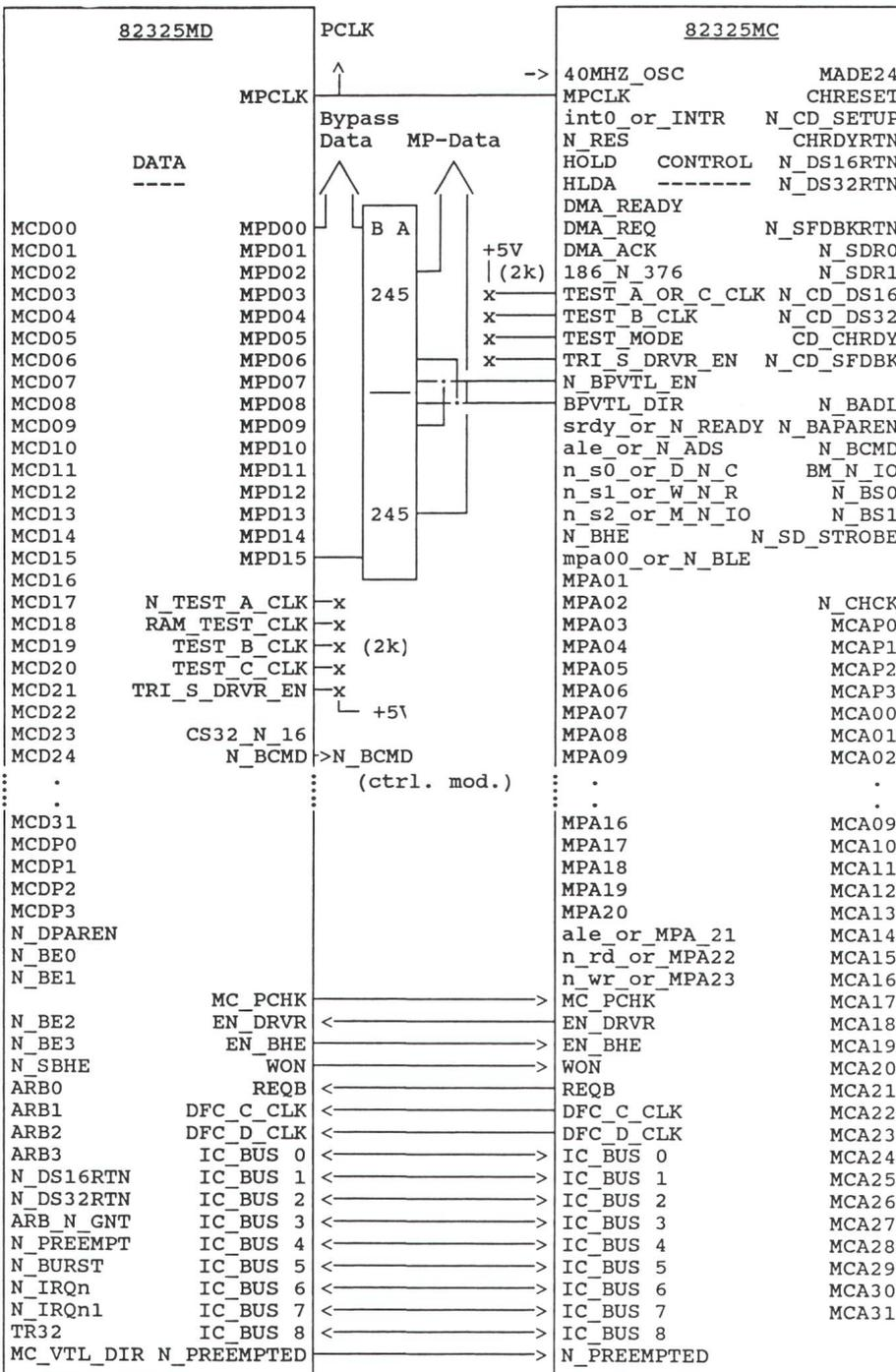
Bild 33a Der Chipsatz 82325 in seiner typischen Schaltungsumgebung
