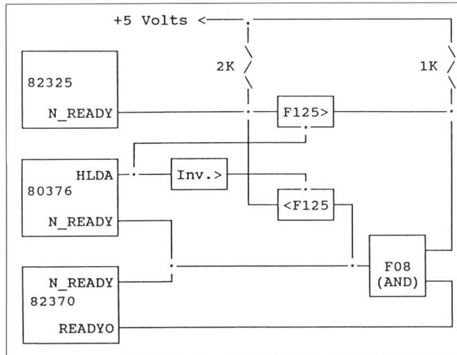
den 82370. Somit kommt die zweite Schaltung erst zum Zuge, nachdem der 82325 die Übertragung abgeschlossen hat. Die umgekehrte Priorität ist durch eine ähnliche Schaltung erreichbar. Das wird zum Beispiel dann nötig sein, wenn der 82370 für den Refresh von Adapter-Speicher eingesetzt wird.
