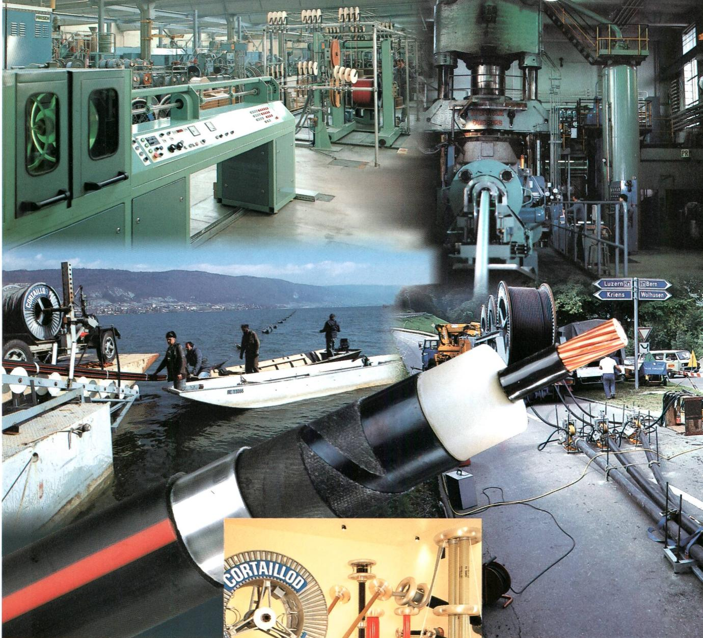
*Câble spécialement bien adapté aux conditions de pose difficile, en milieu humide ou sous pression d'eau (pose sous-lacustre ou en galerie d'eau).*
