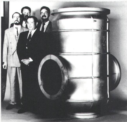
Weltgrösstes SF 6 -Schalter-Gehäuse
