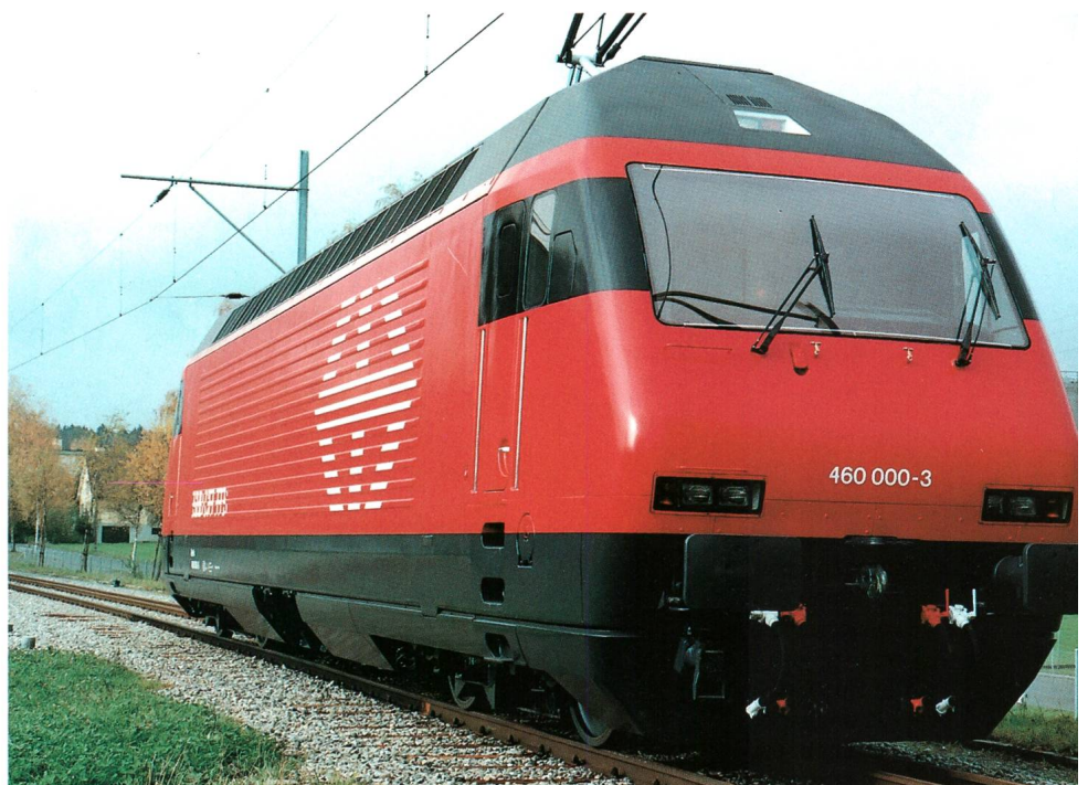
«Locomotive 2000» (Re 4/4 VI) des Chemins de Fer Fédéraux avec une puissance maximale de 6100 kW et une vitesse maximale de 230 km/h. ►
