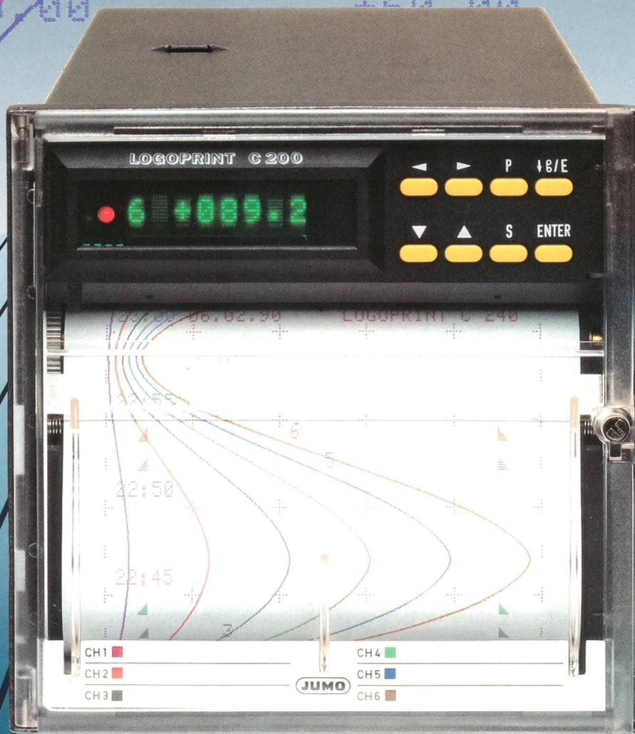
6 galvanisch getrennte Meßeingänge für Spannung, Strom, Widerstandsthermometer und Thermoelemente; frei programmierbar
