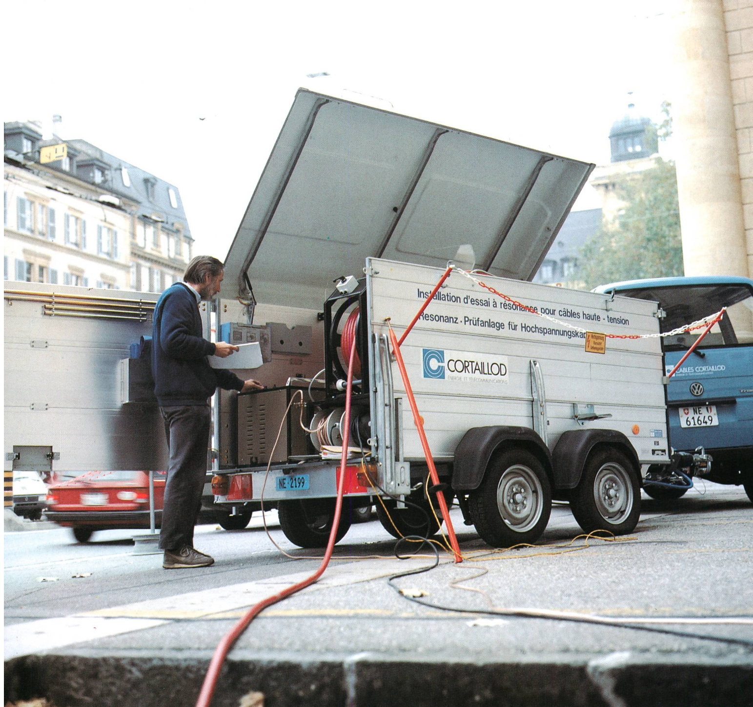
Resonanzprüfanlage für die Vor-Ort-Diagnose der MS-Kabel bis zu 36 kV.
