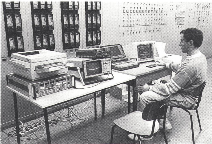
Bild 6 Kommandoraum, niederspannungs- seitiger Teil der Messkette
