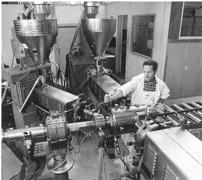
Bild 7 Kontaktrohr- vernetzungsanlage Ansicht mit Extrudern und Dreifachspritzkopf
