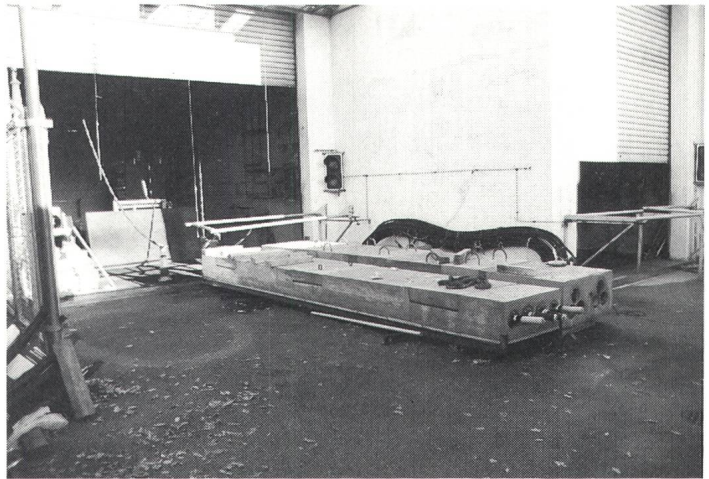
Bild 2 Rohrblock-Muster mit abhebbaren Teilen
