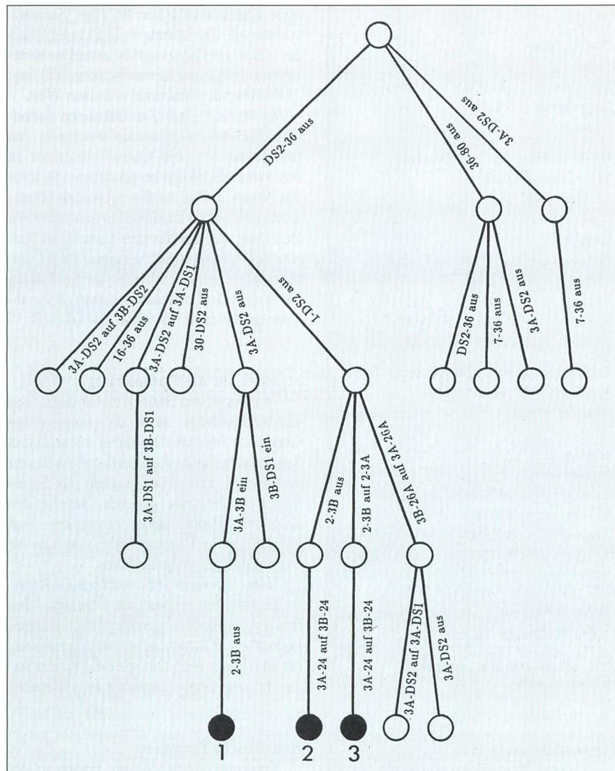
Bild 5 Suchbaum für die Optimierung des Testnetzes
