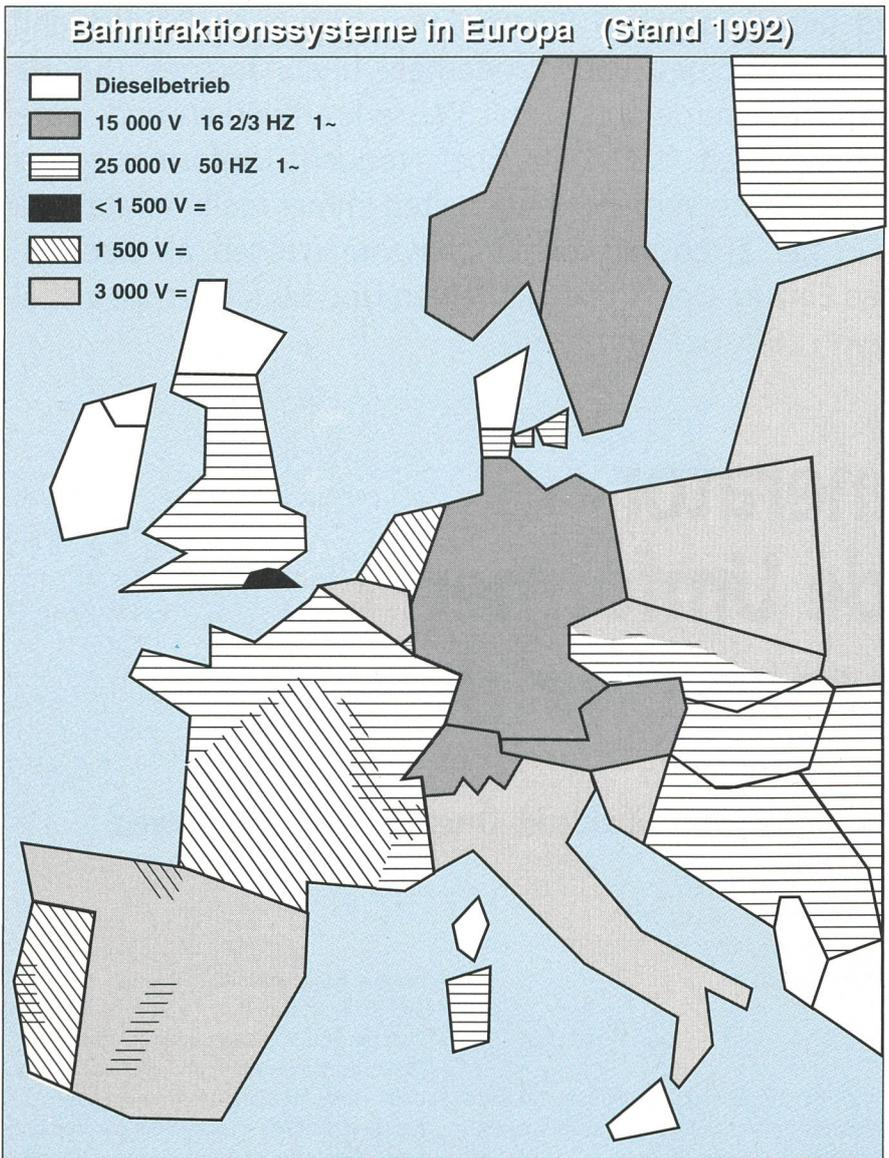
**Bild 1** Übersicht über die in Europa verwendeten Traktionssysteme
