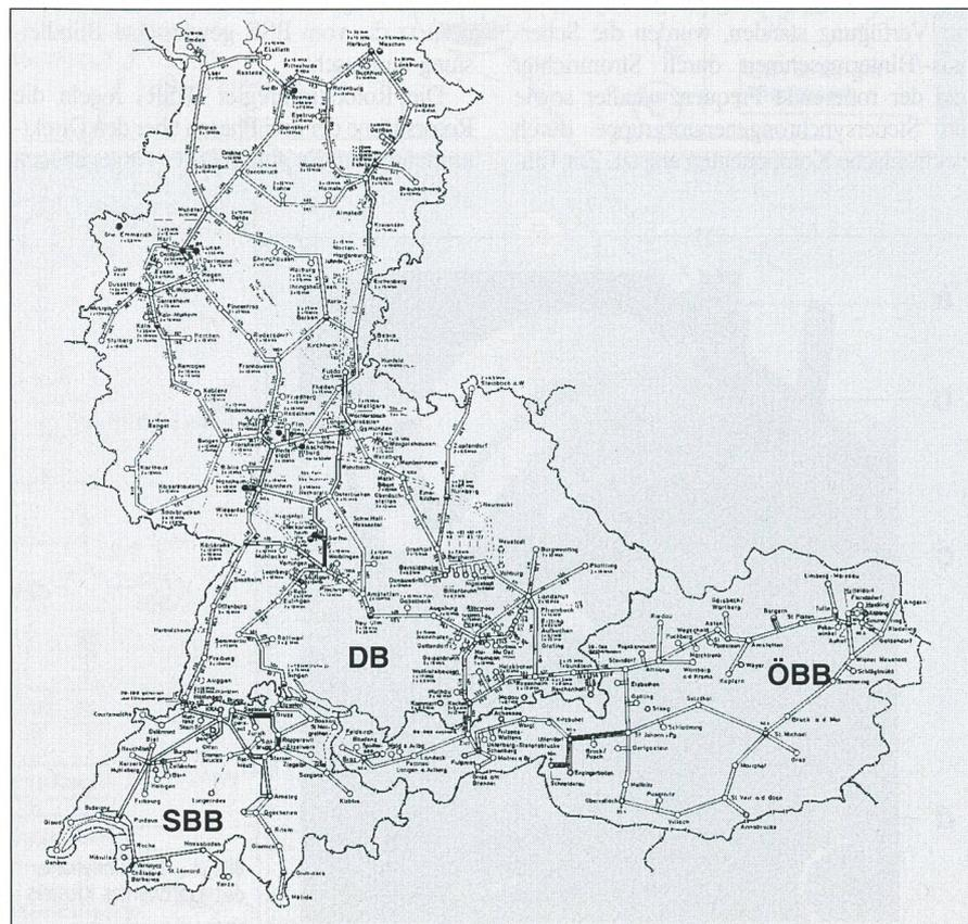
Bild 2 Mitteleuropäisches Bahnstromverbundnetz der DB, ÖBB und SBB
