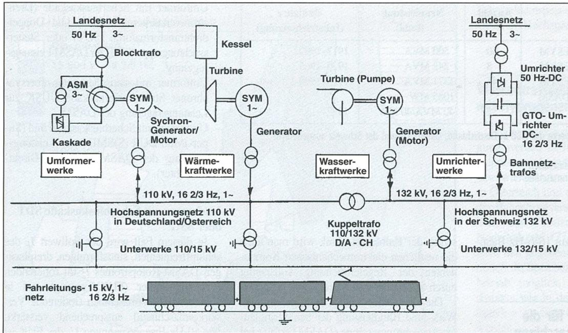
**Bild 3 Bahnstrom-versorgungsanlagen**
