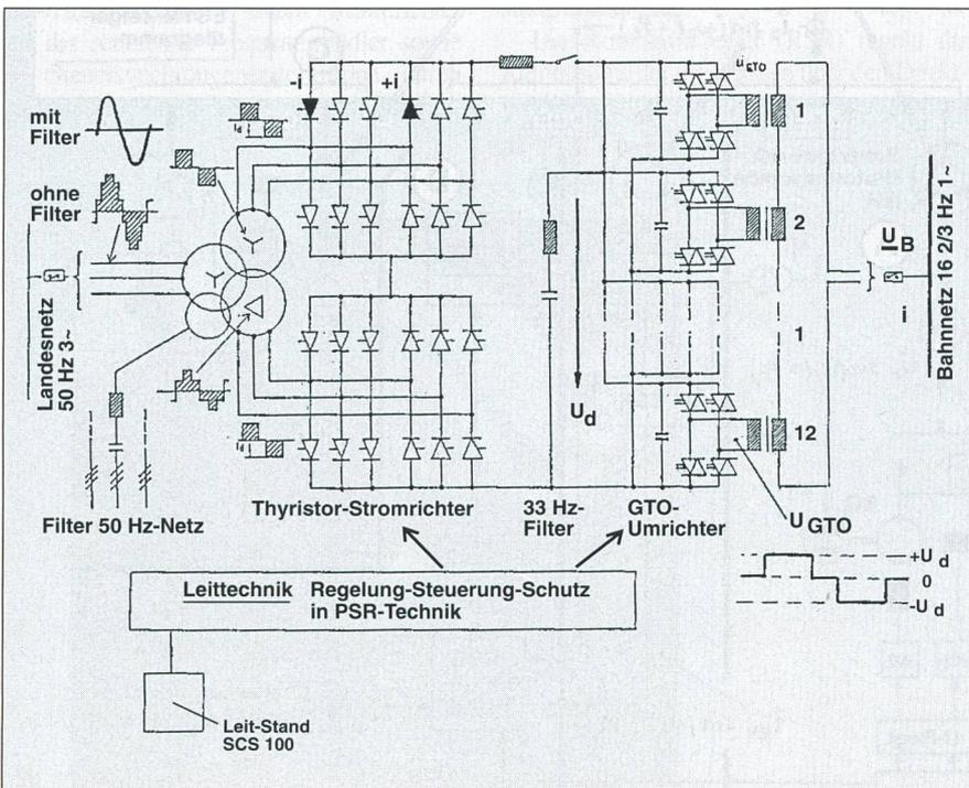
Bild 10 Frequenzelastische Umrichter 50-16<sup>2</sup>/<sub>3</sub> Hz
