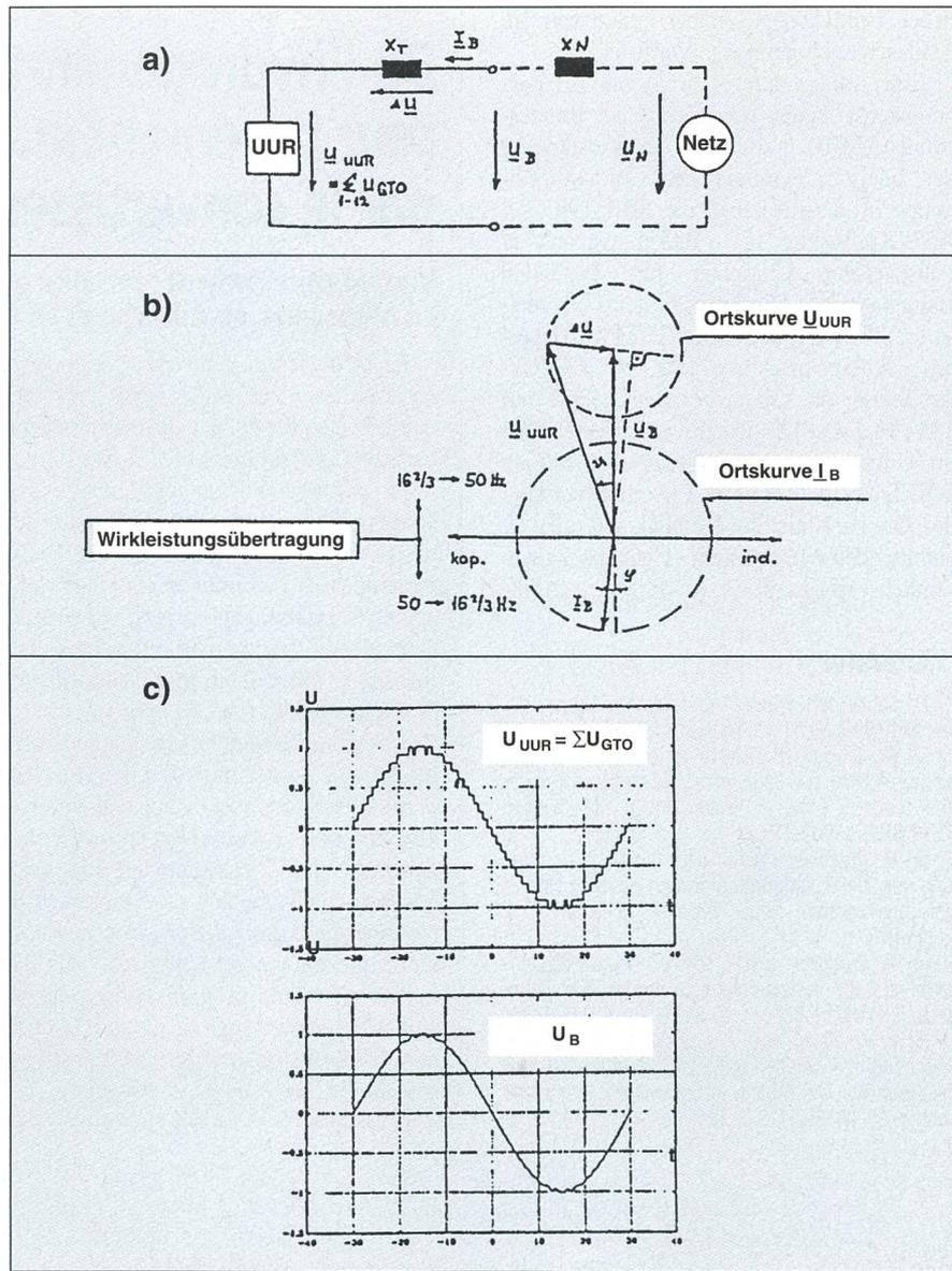
Bild 11 Verhalten eines GTO-Umrichters am Bahnnetz
