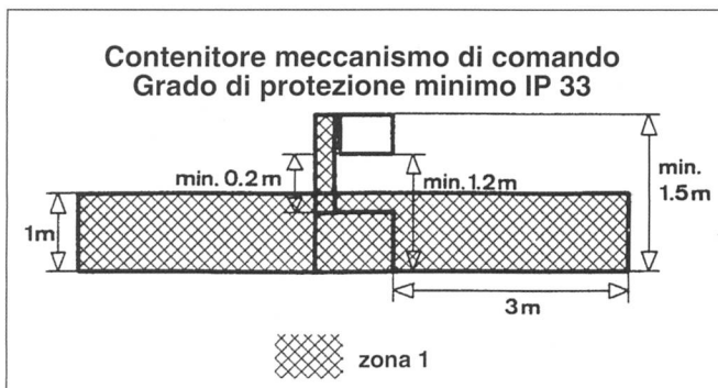
Figura 1 Zone Ex nei pressi di colonne di distributori automatici di benzina (ASE 3307)
