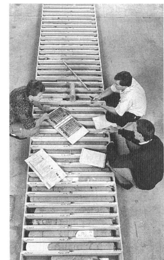
Erdwissenschaftliche Untersuchungen mit Sondierbohrungen sind wichtiger Bestandteil für die Standortwahl von Endlagern. Hier die Analyse von Proben
