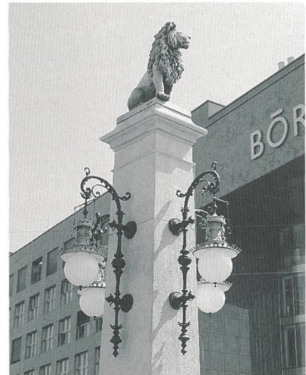
Titelbild: Aufmerksam bewacht: Stromsparende Induktionslampen für renovierte Leuchten vor der neuen Zürcher Börse (Foto: Hans Krebs).
