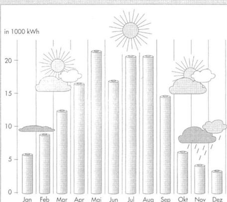
Effektive Produktion von 50 Photovoltaikanlagen im Jahre 1992
