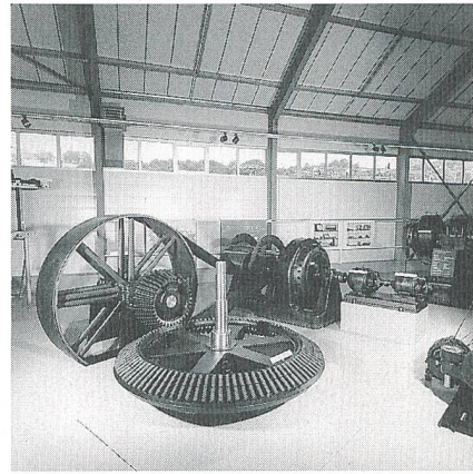
Bild 7 Im BKW-Museum finden sich ausgesprochene Raritäten aus der Zeit der Elektrifizierung (Langsamläufer-Turbine mit Holzzahn-Kammradgetriebe und Lederriemen-Übersetzung)
