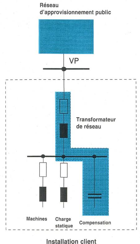
Fig. 3 Circuit équivalent pour alimentation moyenne tension
