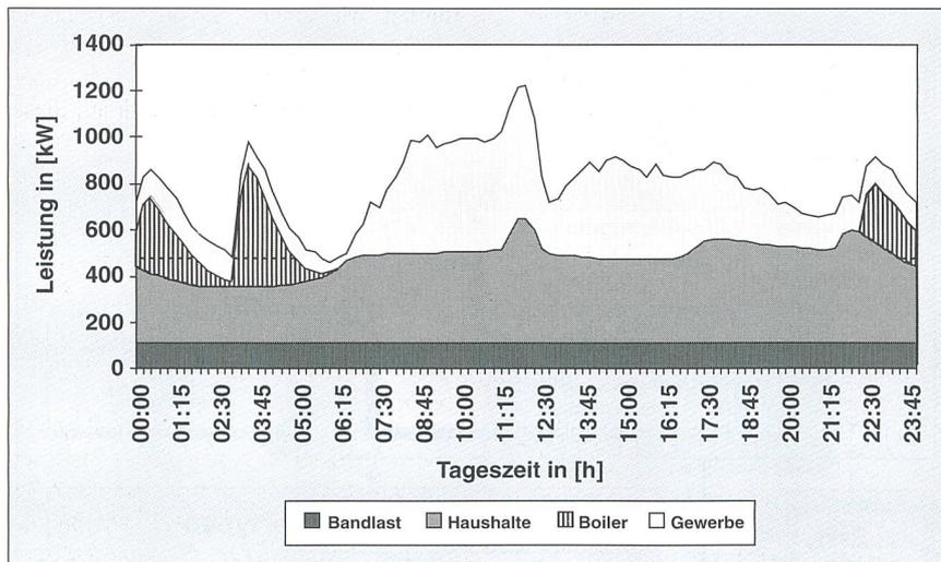
Bild 5 Zusammensetzung der Last an einem Verteiltransformator (aus [1])
