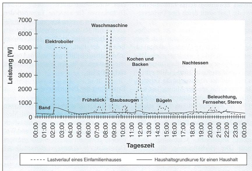
Bild 6 Lastverlauf für ein Einfamilienhaus mit anteilmässiger Haushaltgrundkurve
