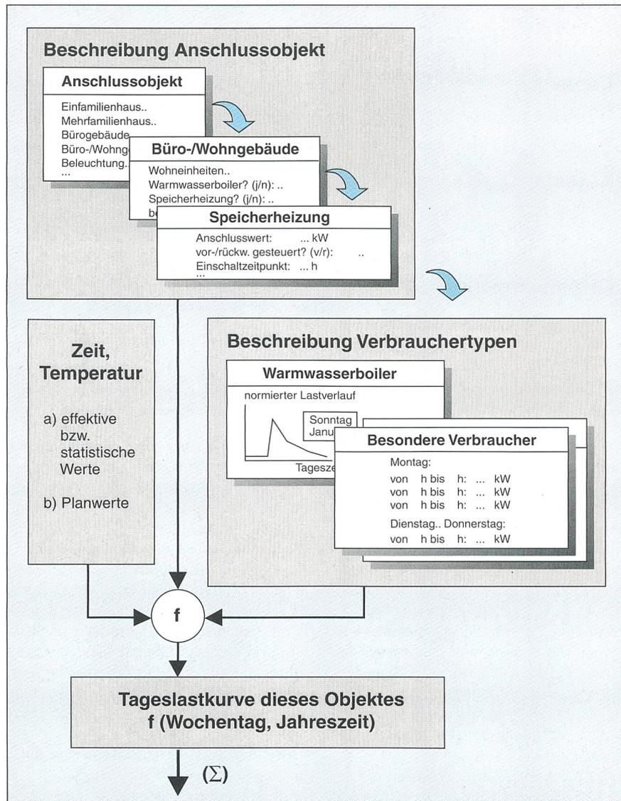
Bild 4 Details zum Lastmodell im Netzinformationssystem nach Bild 3
